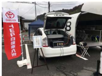
2020年2月 ハイブリッド車から医療機器への 電力供給実証（熊本県）
